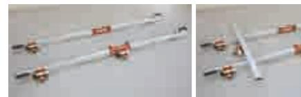
IT Barre / telaio di movimentazione con ventose per formati fino a 160x320 cm.
