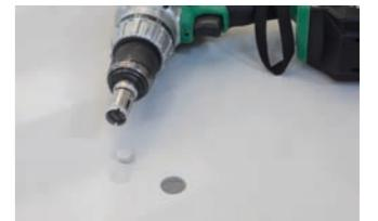
IT 3\_Montenere il trapano/avvitatore ad un angolo di 90° e con una pressione delicata e costante effettuare movimenti circolari con un angolo di circa 5°-10°. Non spingere il trapano/avvitatore diritto verso il basso e accertarsi di avere acqua a sufficienza per bagnare la fresa durante tutta la lavorazione.
