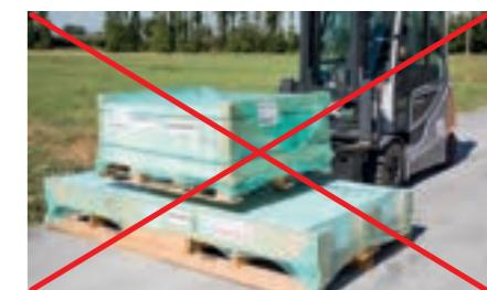
IT Per movimentare correttamente il pallet sul lato lungo si raccomanda di allargare le forche e di posizionarle al centro del pallet, far presa su tutta la profondità prima di sollevarlo.
