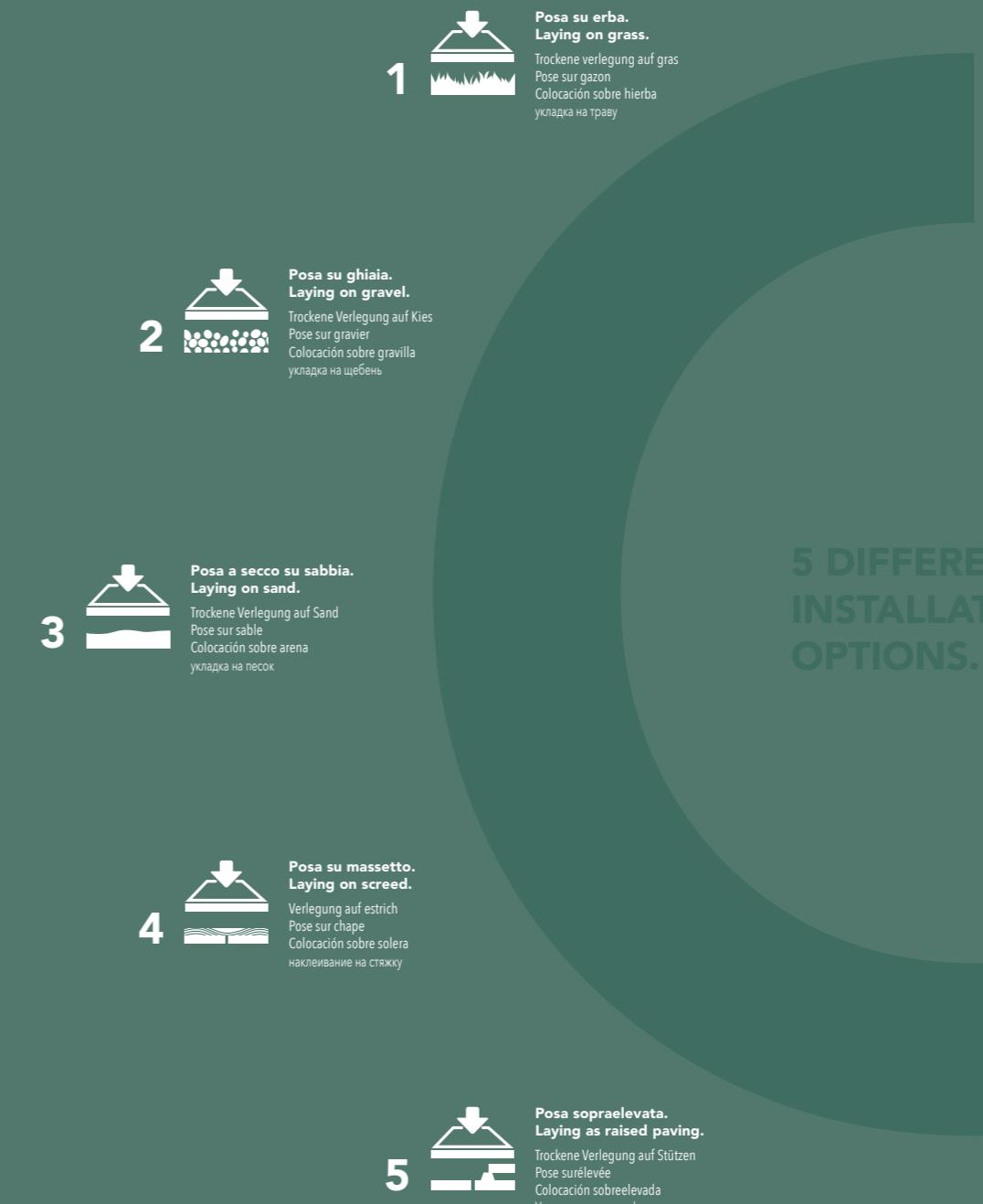
OPEN ermöglicht eine schnelle und einfache Trockenverlegung und durch die traditionelle Verlegung auf Unterbetonblöcken auch die Fertigstellung von Bereichen, die extreme Leistungen erfordern. OPEN ist auch im Falle einer hochgestockten Verlegung unvergleichlich, und ermöglicht bestehende Böden zu überdecken oder Raum für technische Bodeninstallationen zu schaffen.
