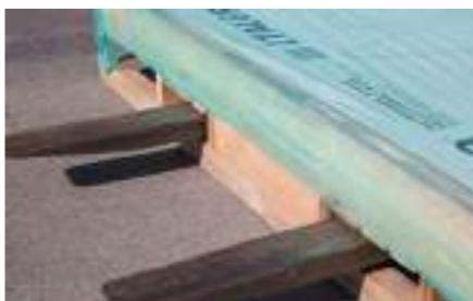
IT Per movimentare correttamente il pallet sul lato lungo si raccomanda di allargare al massimo le forche e di posizionarle al centro del pallet, far presa su tutta la profondità prima di sollevare.
