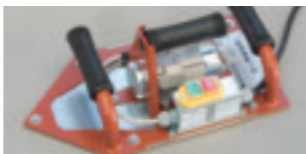
BATTITORE A VIBRAZIONE O FRATTAZZO IN GOMMA ANTRIMBALZO. TILE VIBRATOR OR RUBBER ANTI-BOUNCE BEATER.
