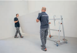
IT Carrello di movimentazione predisposto per eseguire la stesura della colla sul retro lastra. EN Handling trolleys designed to allow application of adhesive to the back of the slab.
