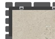
Applicare il pannello al supporto murario precedente verificato e spatalato con collante, utilizzando il profilo di partenza come base per l'allineamento. Fissare il pannello con appositi tasselli ad espansione in base al tipo di supporto al muro avendo cura di non avvitare troppo il tassello per non disallineararlo rispetto alla muratura.
