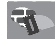
Nel caso sia presente un muro intonacato verificare la tenuta dello strato superficiale, e se necessario, eliminare e ripristinare i punti critici.
