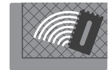
Preparare il collante con classificazione C2TES1 ed applicarlo tramite una spatola dentata da 10 mm con la tecnica della doppia spalmatura.
