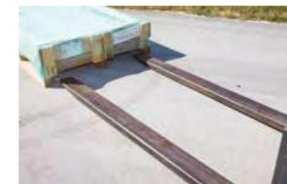
**IT** Per movimentare correttamente il pallet sul lato corto (ad esempio nello scarico dei container) è raccomandato l'utilizzo di forche lunghe almeno 2,5 mt, questo garantisce una perfetta presa e sicurezza del materiale.
